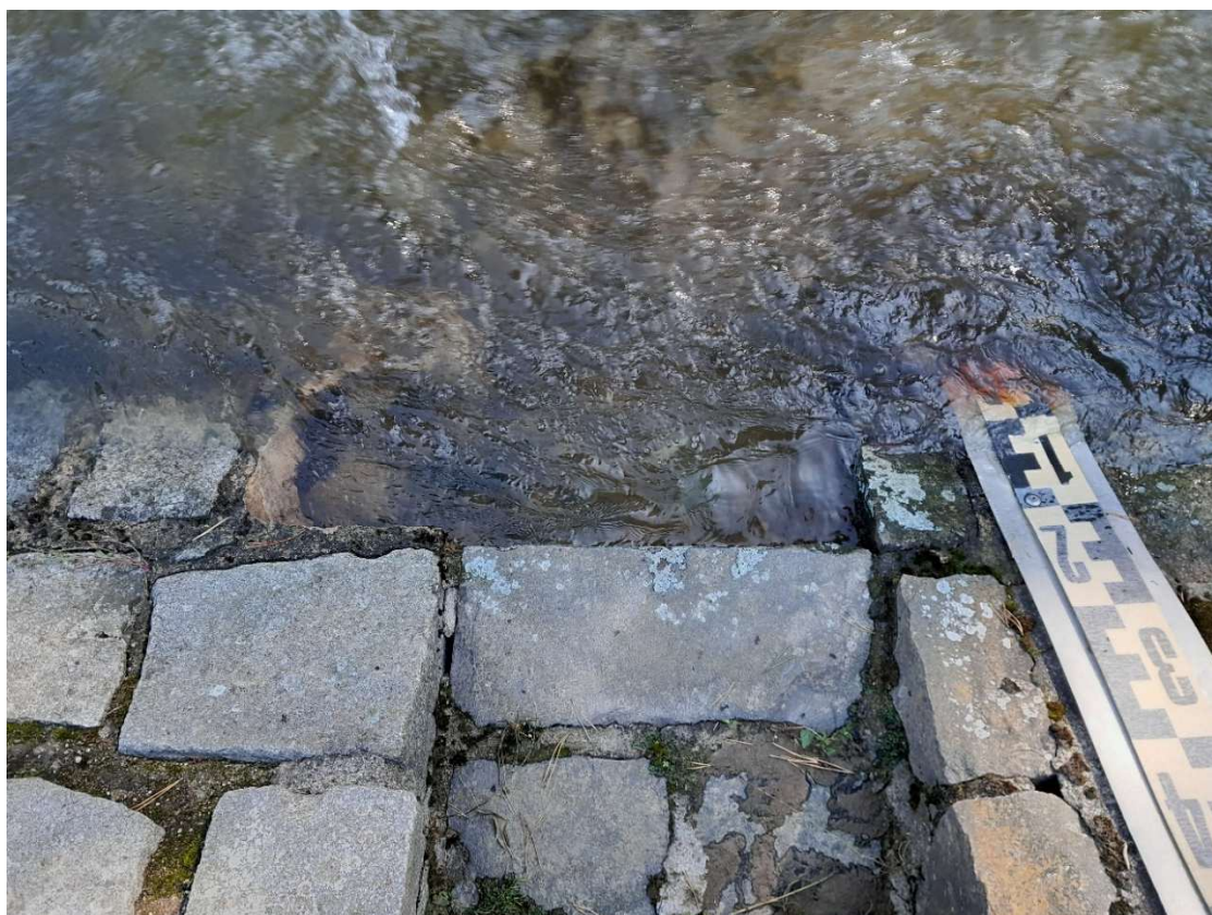
10. Detail umístění vodočetné latě LMG
